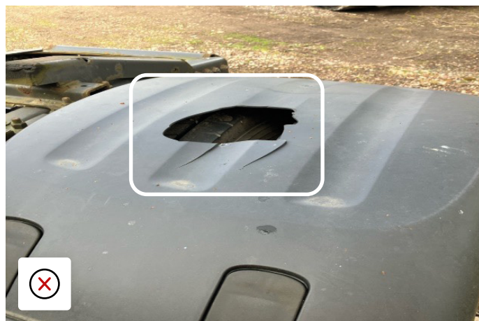
Topskærm skadet uacceptabel
