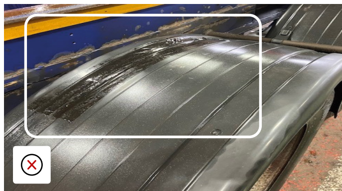
Repareret skærm kræver udskiftning
