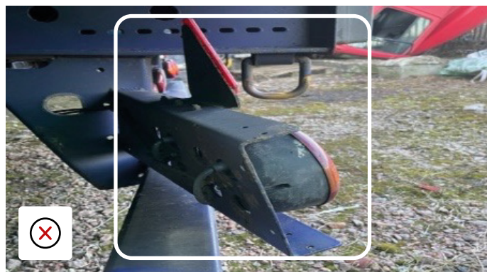
Lygteplade bøjet og kræver reparation
