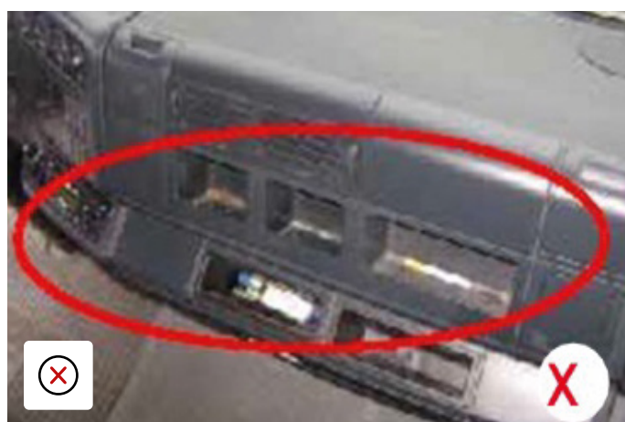
Instruments afblændingsdæksler mangler uacceptabel
