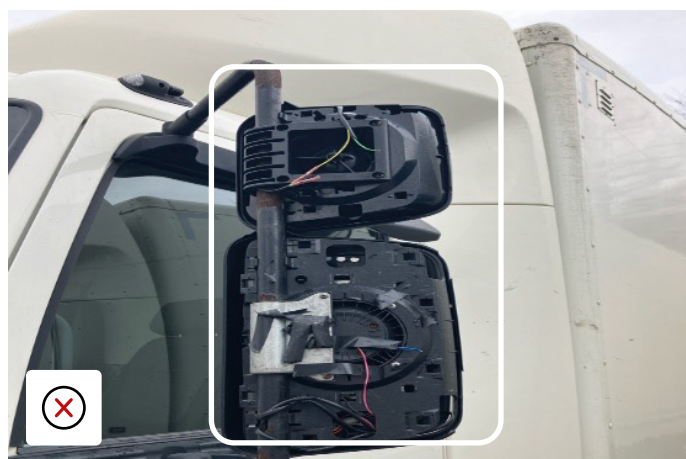
Spejl skadet uacceptabel
