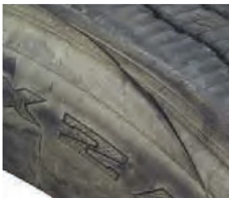
Dyb flænge i karkasse i dæk, skulder og skader på sidevæggen.
