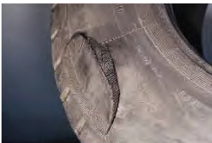
Udblæsning af sidevæggen på grund af gennemtrængning af den indre linje.
