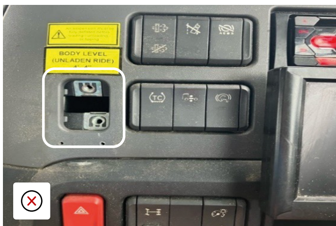
Instrumentbræts huller uacceptabel
