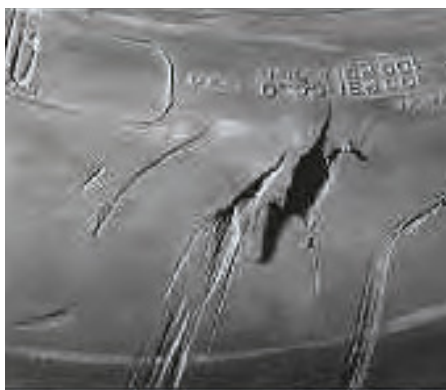
Dyb gennemtrængning af sidevæg skade på dæk.
