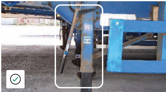
Støtteben er lige med håndsving i sikret position.
