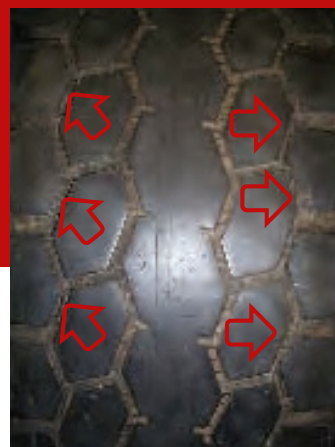
Revnedannelse i slidbanesporet på grund af for højt dæktryk
