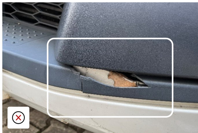
Kofanger skadet uacceptabel
