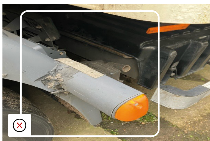
Sideblinklys skadet uacceptabel
