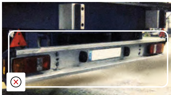
Afskærmningen mod underkørsel er bøjet og skal repareres
