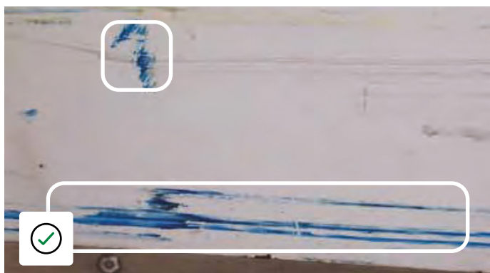
GRP-side ridset af paller, men gelcoat ikke gennembrudt.
